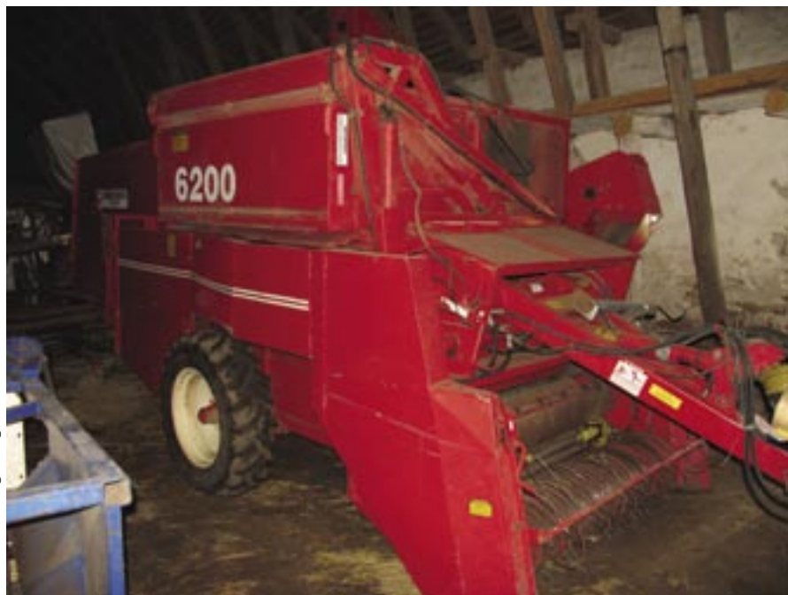
Bild 6. Böntröska. Pick-up bord på tröska avsedd för skörd av fältböter.
